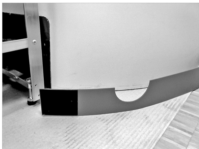
Abb. 51: Fußrand mit den Ausschnitten nach oben legen
