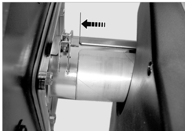
Abb. 11: Brenner bis zum Anschlag einschieben
