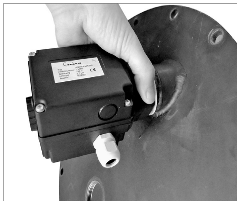
Vissage des résistances électriques chauffantes
