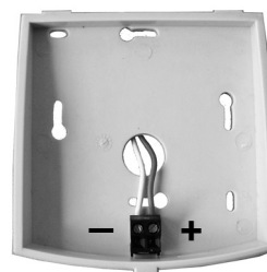
Collegamento della sonda ambiente
