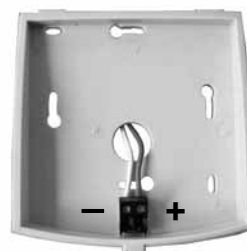
Collegamento della sonda ambiente
