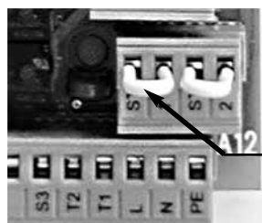
ST1/ST2 avec un pont sur ST - 2
