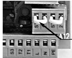
ST1/ST2 mit Brücke auf ST - 2
