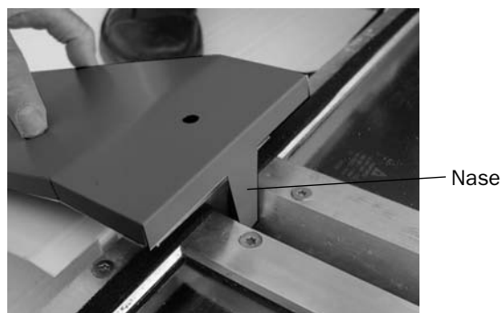
Fig. 68: Posizionare la connessione con l'aletta per la lamiera superiore, allineare ed avvitare con forza il tutto
