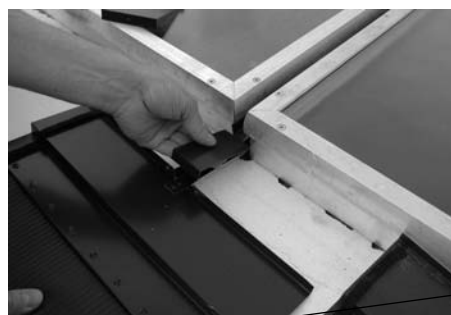
Fig. 49: Inserire la connessione centrale per i grembiuli
