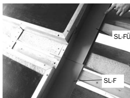
Fig. 159: Montare la lamiera laterale superiore SL-FÜ
