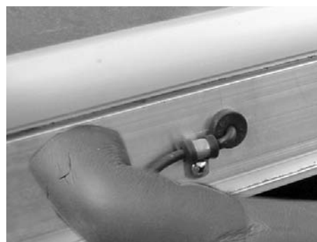
Fig. 225: Applicare la staffa per il cavo
