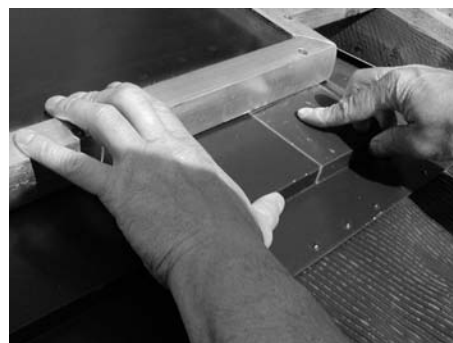
Fig. 46: Premere ed allineare fissaggi ed angoli
