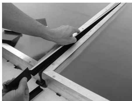
Fig. 146: Posizionare il componente centrale verticale
