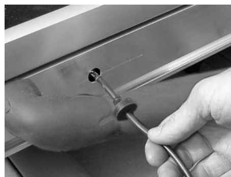
Fig. 223: Inserire la sonda nella bocchetta di immersione
