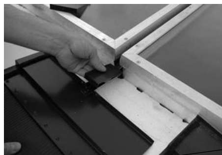
Fig. 147: Inserire la connessione centrale per i grembiuli
