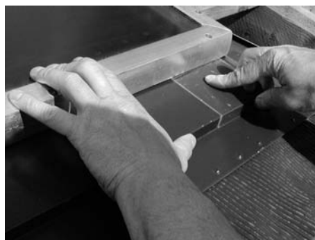
Fig. 46: Premere ed allineare fissaggi ed angoli
