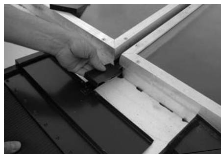
Fig. 147: Inserire la connessione centrale per i grembiuli
