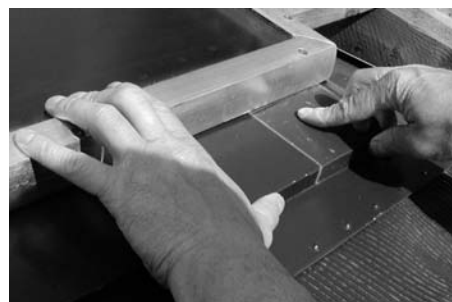
Fig. 91: Premere ed allineare fissaggi ed angoli
