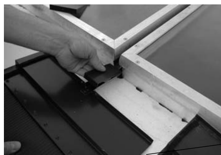
Fig. 49: Inserire la connessione centrale per i grembiuli
