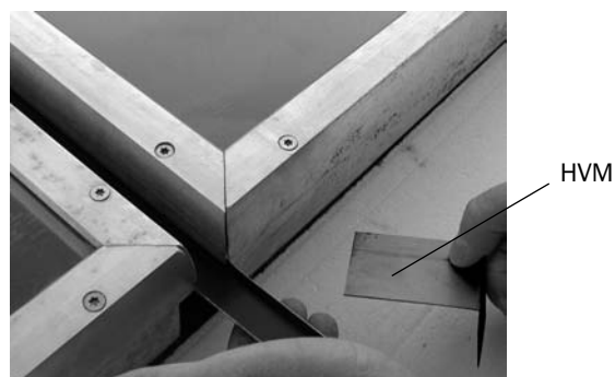
Fig. 150: Inserire la lamiera di arresto per la parte centrale verticale (HVM)
