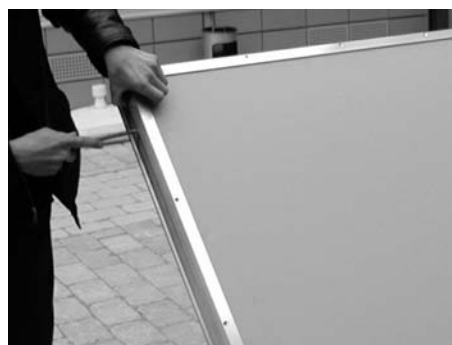
Fig. 191: Togliere il profilato a clip e il cartone di copertura
