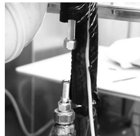
Stützhülsen und Klemmringverschraubungen
