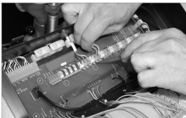
Abb. 26: Elektrischen Anschluss beim SX lösen
