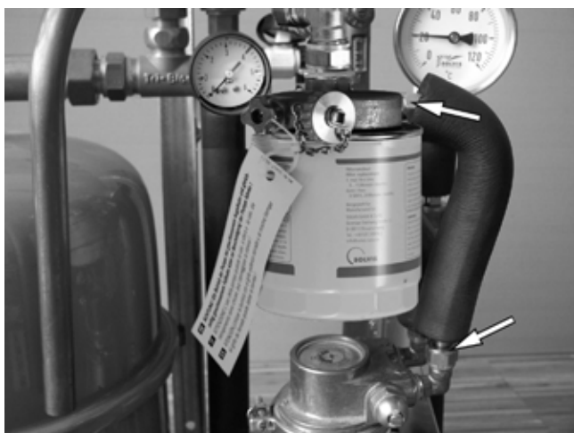
Abb. 9: Filter und Rohr an Pumpe (Druckseite) montieren
