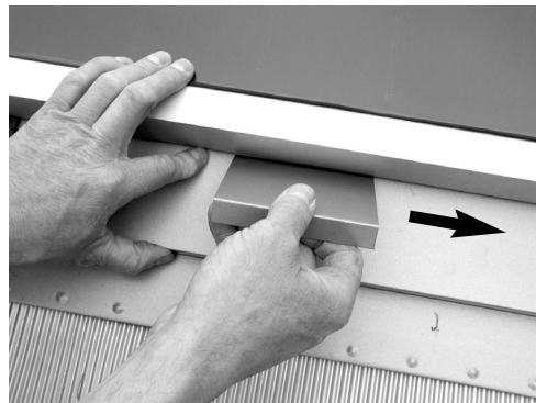
Bleischürzenfixierung einsetzen und nach rechts schieben
