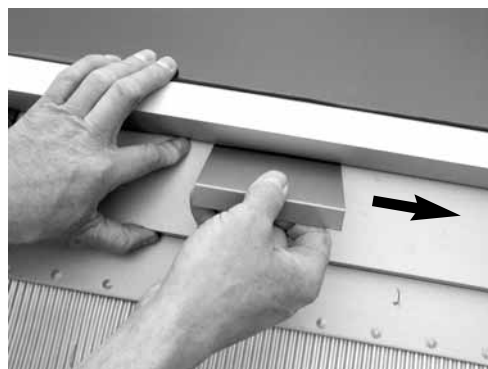
Bleischürzenfixierung einsetzen und nach rechts schieben
