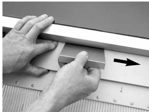
Bleischürzenfixierung einsetzen und nach rechts schieben
