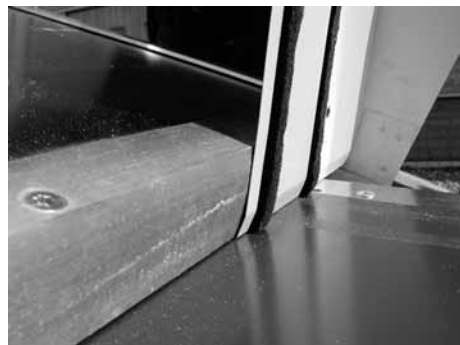
Oberteil Zwischenblechecke einsetzen
