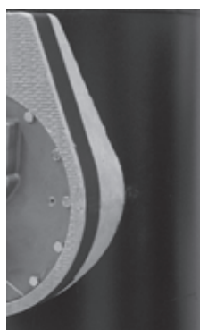
Hintere Flanschisolierung befestigt
