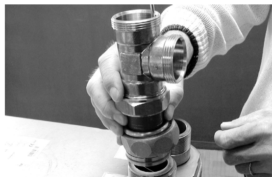
Anschluss- mit T-Stück montieren
