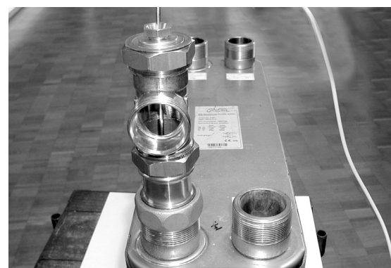
Fühler fertig montiert
