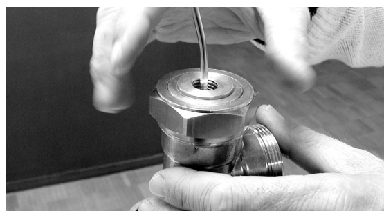
Klemmringverschraubung und Fitting einlegen und Überwurfmutter handfest anziehen
