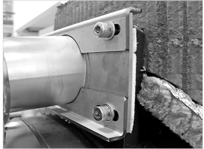
Abb. 1: Verstärkung am Abgasanschlussflansch
