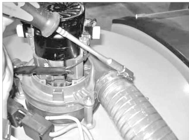
Abb. 8: Luftschlauch an Turbine anschließen
