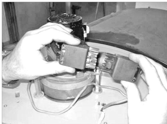
Abb. 3: Stecker Saugturbine anschließen
