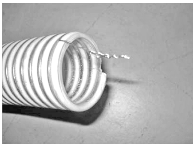
Abb. 15: Erdungslitzen 3 – 5 mm freilegen
