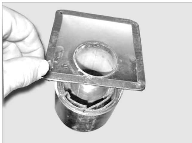
Abb. 13: Flansch mit Dichtband versehen
