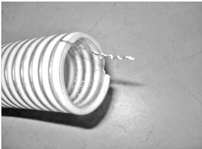
Abb. 20: Erdungslitzen 3 – 5 mm freilegen
