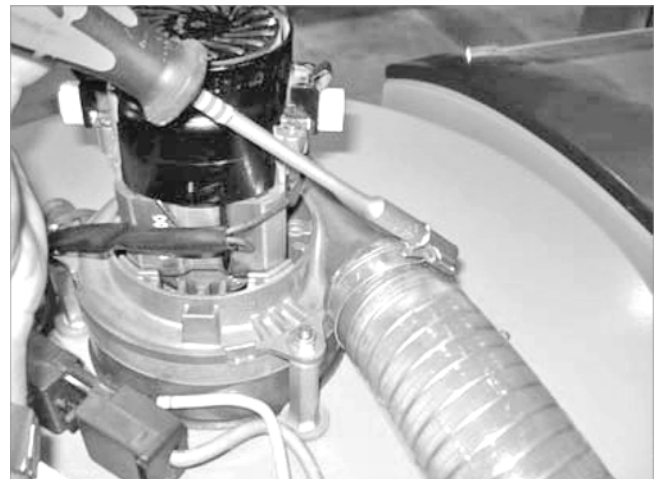
Abb. 8: Luftschlauch an Turbine anschließen
