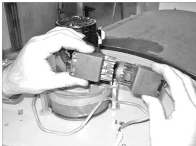
Abb. 3: Stecker Saugturbine anschlie \ddot{u} en
