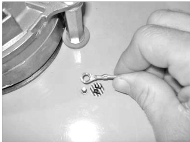
Abb. 5: Erdungskabel anschlie \ddot{u} en
