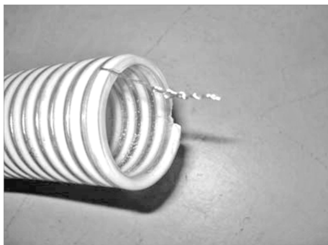
Abb. 15: Erdungslitzen 3 – 5 mm freilegen
