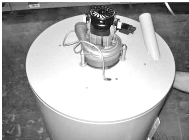
Abb. 2: Neuer Beh \ddot{a} lterdeckel aufgesetzt
