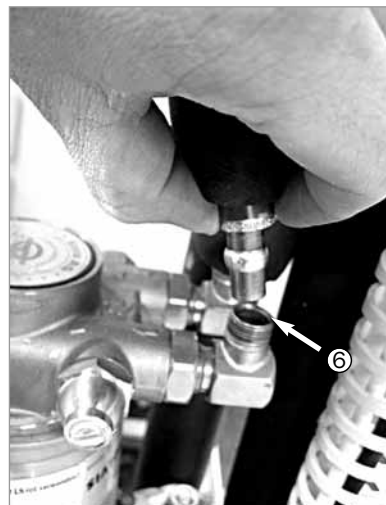
Verbindungsrohr an Pumpe montieren
