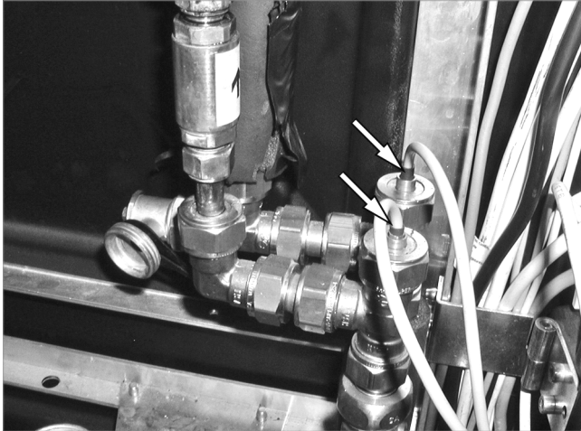
Abb. 8: Fühler (Pfeile) herausziehen
