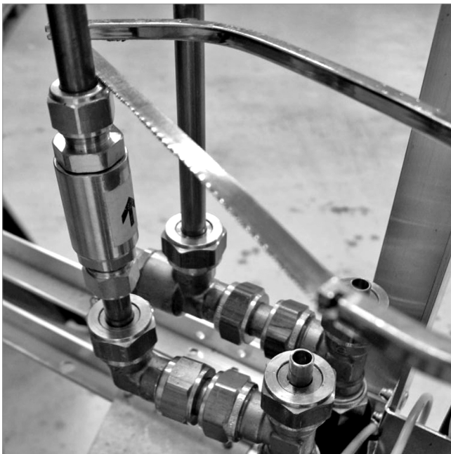
Abb. 9: Oberen Anschluss durchtrennen
