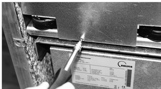
Abb. 6: Vorderes Gehäuseteil an Grundplatte verschrauben
