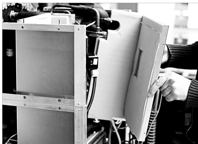
Abb. 5: Vorderes Gehäuseteil einsetzen
