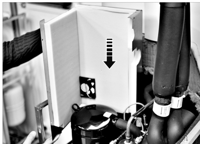
Abb. 4: Hinteres Gehäuseteil einpassen
