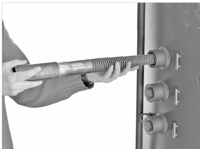
Fig. 5: Inserire la lancia di carico ed ermetizzarla
