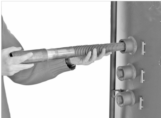
Fig. 11 : Insertion et étanchéification de la lance de chargement.
