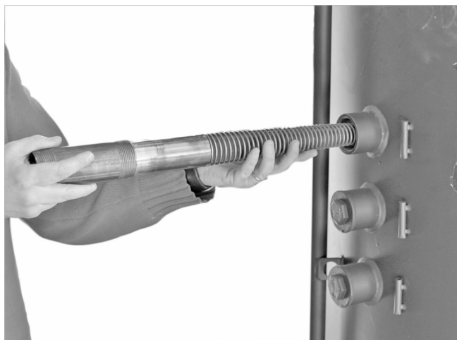
Afb. 13: Laadlans inschuiven en afdichten
