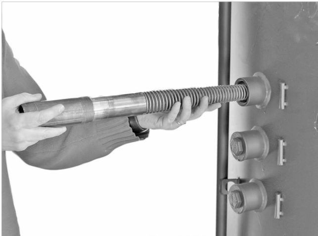
Abb. 1: Beladelanze einschieben und eindichten
