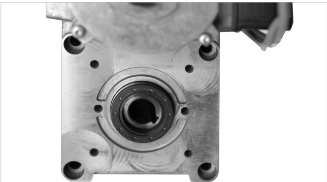
Abb. 5: Dichtring gerade aufgelegt
