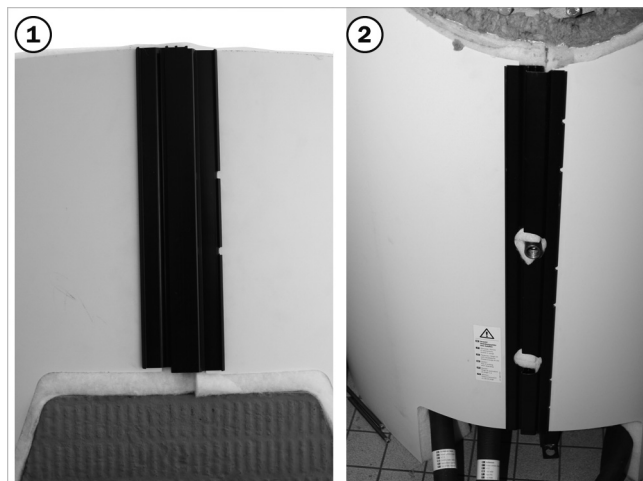
Abb. 52: Isolierung oben (1) und unten (2) schließen
