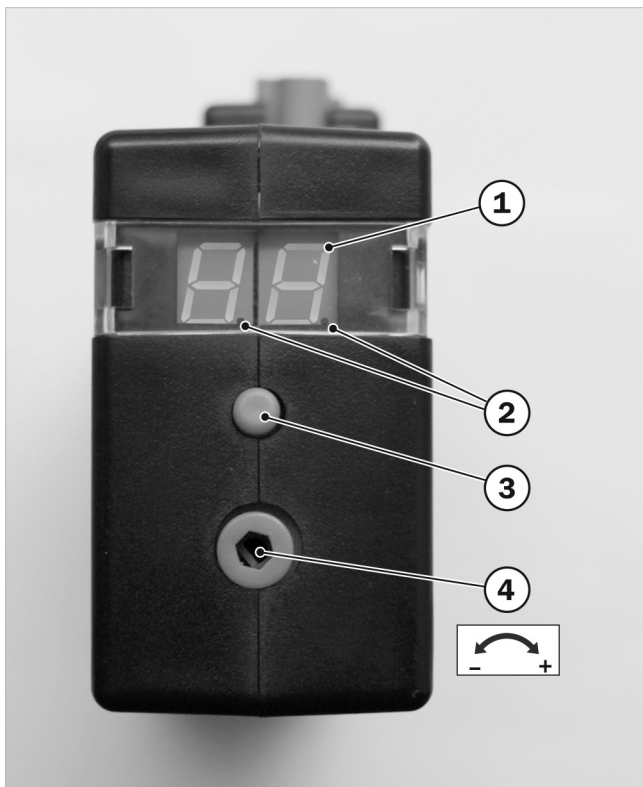
Abb. 62: Gebläsedrehzahl am Bediengerät einstellen
