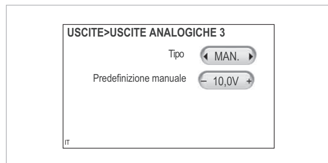
Fig. 19: Impostazione di „Predefinitone manuale“ su 10 V (solo 0-3)
