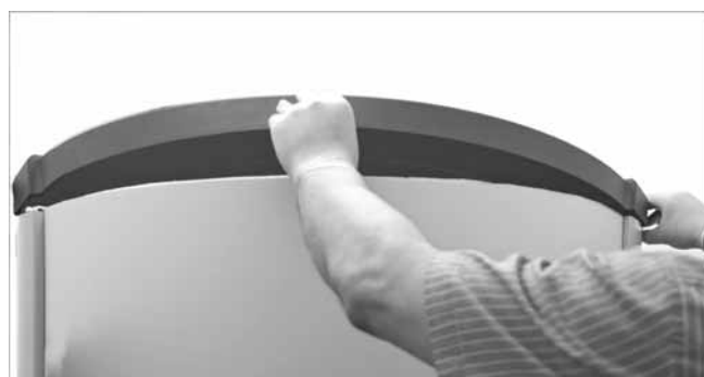
Fig. 10: Colocar a cobertura superior
