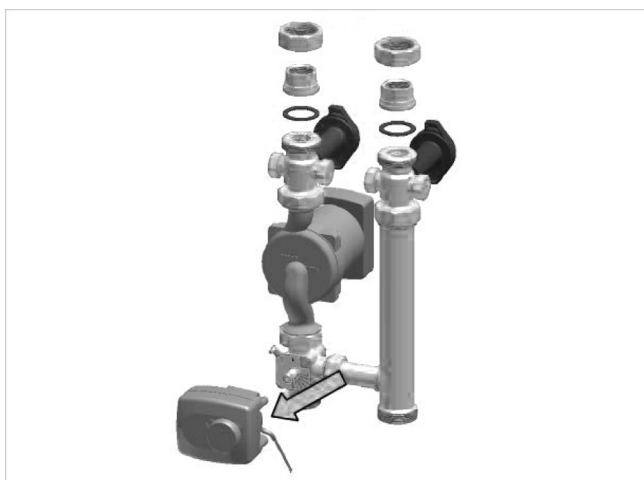
Fig. 6: Retirar a unidade de acionamento da misturadora
