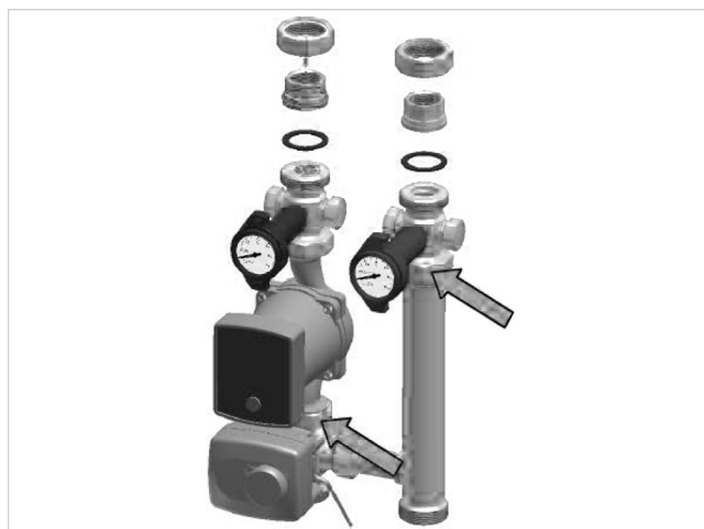
Fig. 4: Soltar as ligações roscadas
