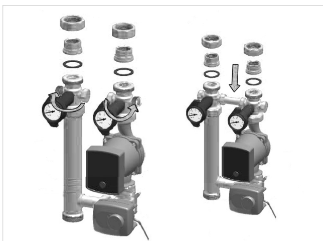
Fig. 8: Montar o tubo cego
