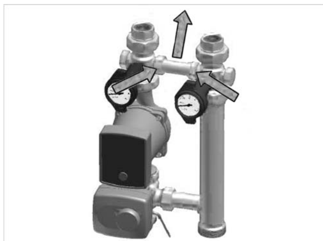
Fig. 3: Remover o tubo cego
