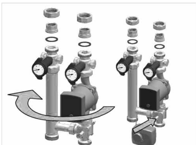
Fig. 7: Mudar a posição da unidade de acionamento na misturadora
