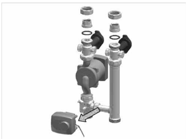
Fig. 6: Retirar a unidade de acionamento da misturadora
