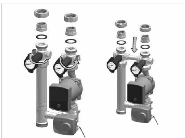
Fig. 8: Montar o tubo cego
