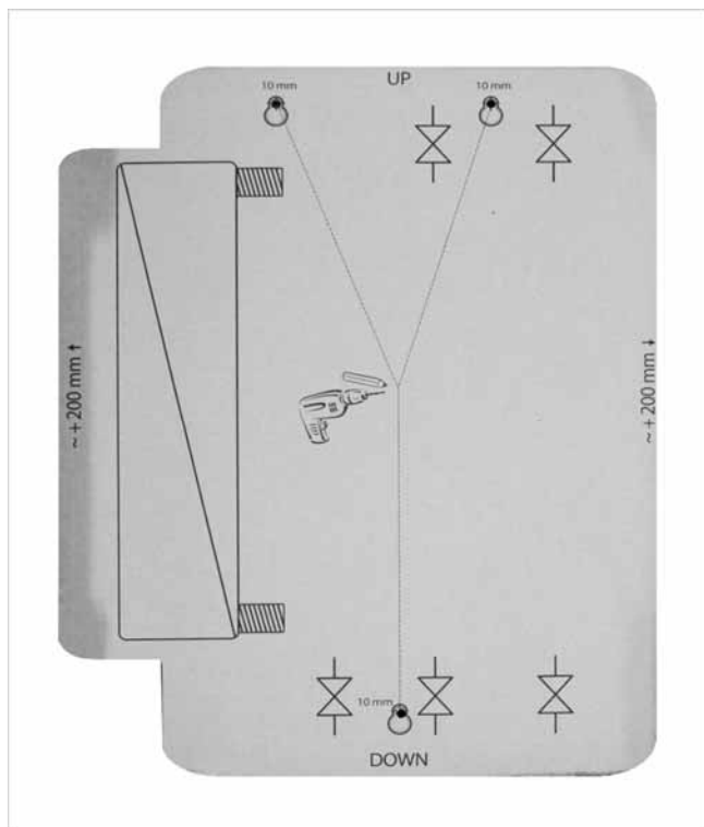
Fig. 1: Drilling template SÜS-50-HE / SÜS-90-HE
