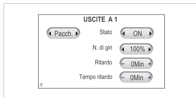
Fig. 14: Inserimento della pompa solare
