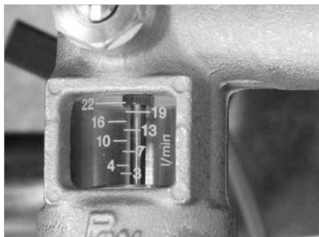
Fig. 18: Lettura del flusso volumetrico nel bordo superiore del galleggiante
