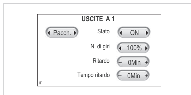
Fig. 14: Inserimento della pompa solare
