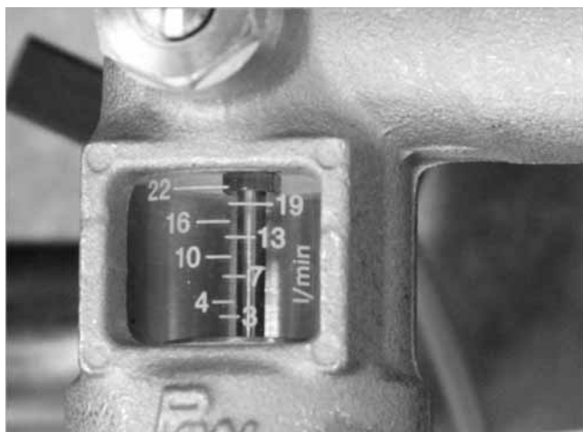
Fig. 18: Lectura del caudal volumétrico en el borde superior del cuerpo flotante
