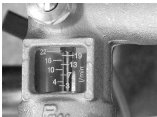
Fig. 18: Ler o caudal volumétrico no canto superior do flutuador
