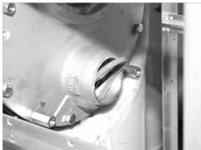
Abb. 22: Abgasdichtung durch neue ersetzen
