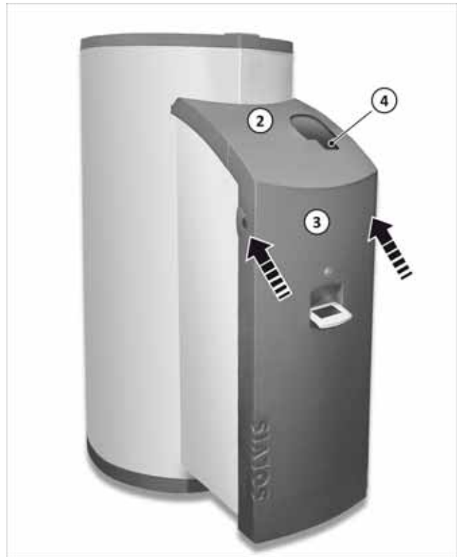
Abb. 33: Frontverkleidung vollständig montieren
