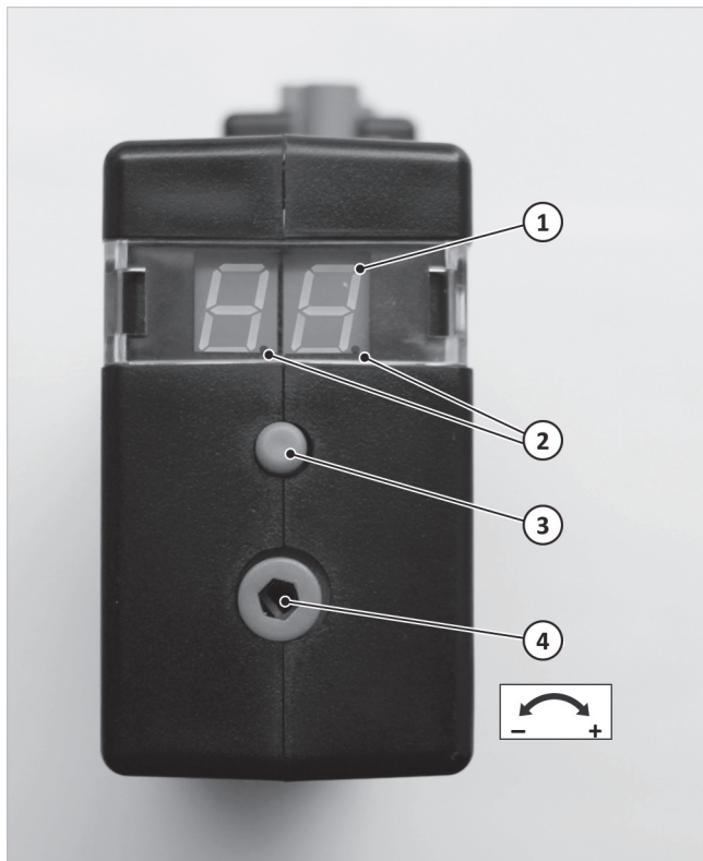
Abb. 39: Interface Feuerungsautomat CM 168
