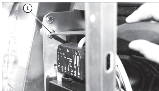
Abb. 31: Schnellverschlusschrauben an Brennereinsatz
