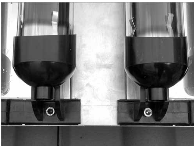
Abb. 31: Verbindungsblech unten bündig eingelegt, Röhren verschraubt
