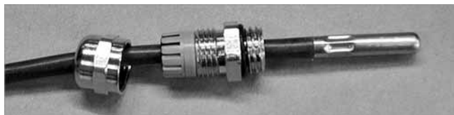
Abb. 36: PG-Verschraubung auf Tauchsensoren schieben
