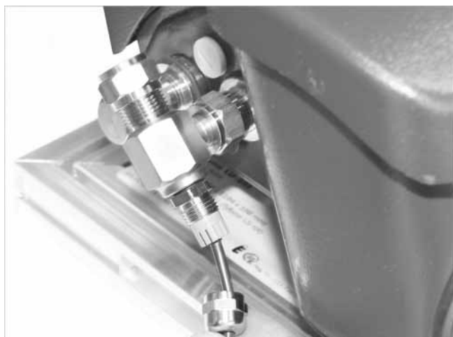
Abb. 37: Sensor bis zum Anschlag einstecken
