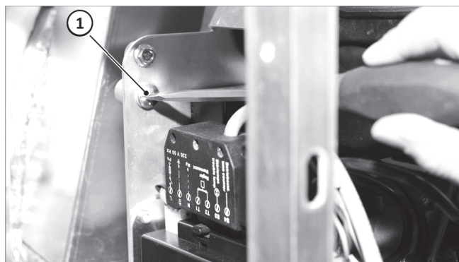
Fig. 31: Viti a serraggio rapido nell'inserto del bruciatore
