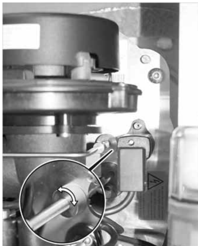
Fig. 38: Dado zigrinato (collegamento tubazione gasolio / supporto ugello)
