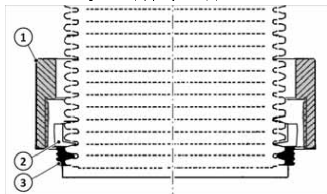
Fig. 10: Unión roscada instalada
