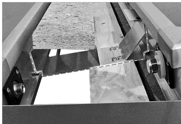
Fig. 61: posizione dei distanziali del collettore nei collettori
