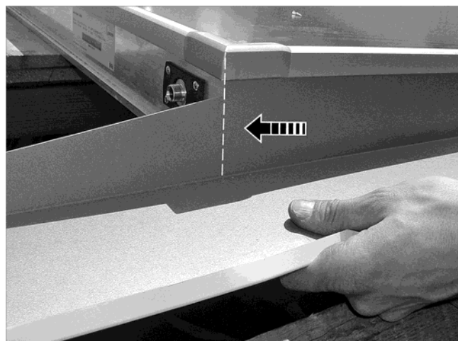
Fig. 64: spinta della lamiera superiore laterale verso l'alto contro la battuta
