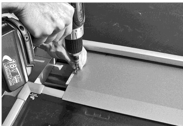
Fig. 71: Atornillar la chapa intermedia a unos 10 mm del borde exterior izquierdo
