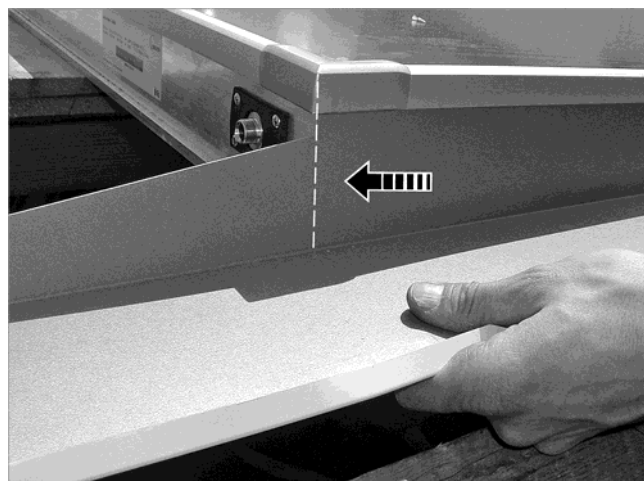
Fig. 64: Empujar la chapa lateral superior hacia arriba contra el tope
