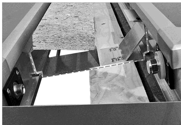
Fig. 61: Posición de los distanciadores en los colectores
