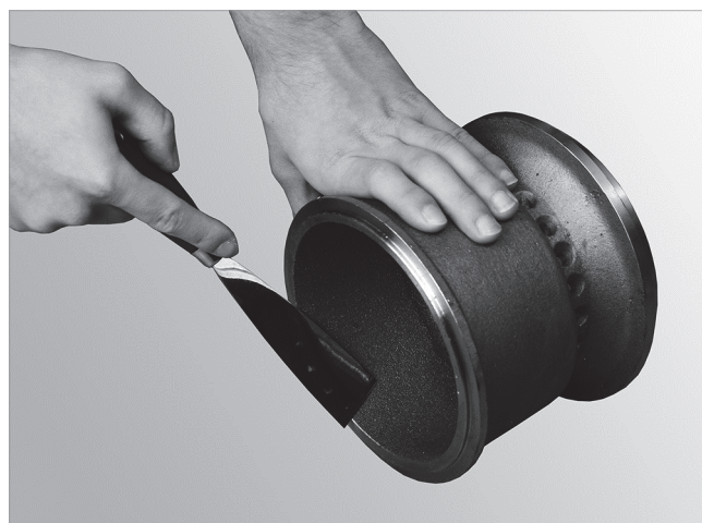
Abb. 146: Konus mit Spachtel reinigen
