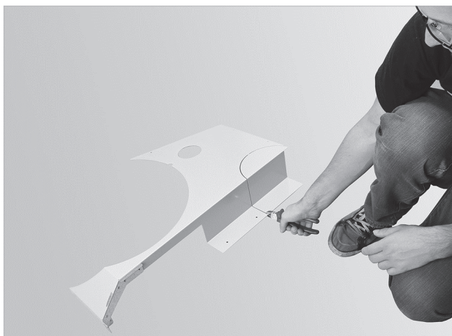
Abb. 76: Nur bei Abgasanschluss nach oben ausbrechen
