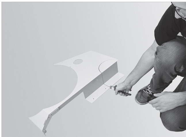
Abb. 45: Nur bei Abgasanschluss nach oben ausbrechen
