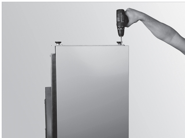
Abb. 51: Jeweils 1 Kreuzschraube entfernen
