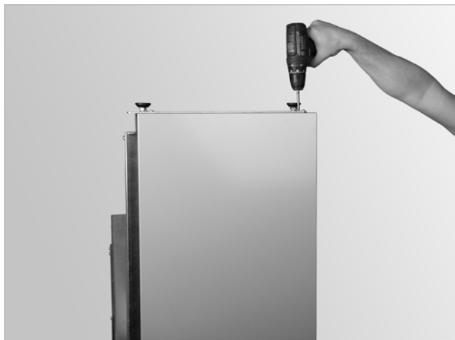
Abb. 51: Jeweils 1 Kreuzschraube entfernen
