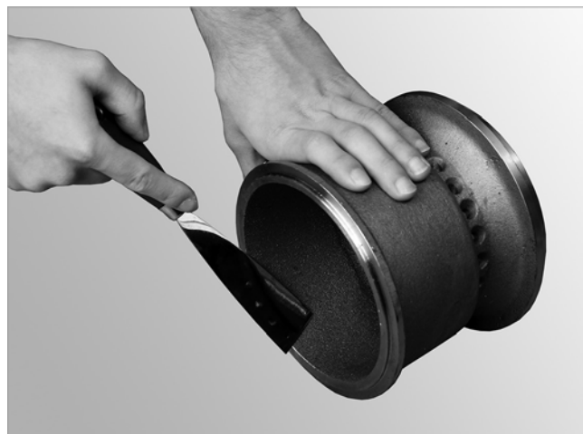
Abb. 146: Konus mit Spachtel reinigen
