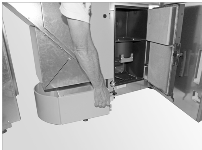
Abb. 101: Aschebehälter einschieben (LI-4-xx-VO)
