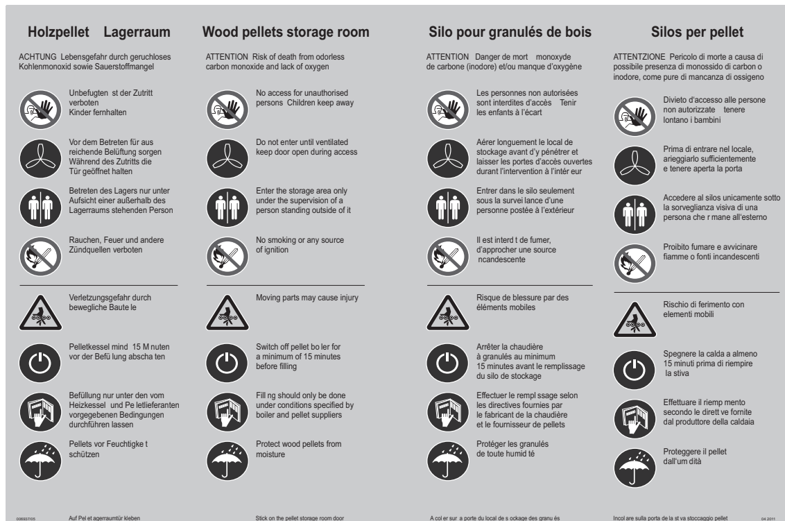
Abb. 92: Aufkleber für Lagerraumtür
