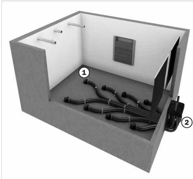
Abb. 2: Pelletlagerraum mit 8-Saugsonden-System
