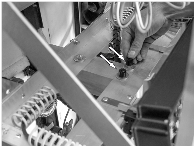
Abb. 10: Schraubenköpfe an Konsole abdecken
