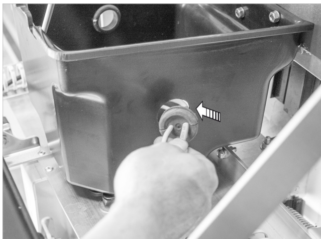
Abb. 12: Brennerkabel luftdicht durchleiten
