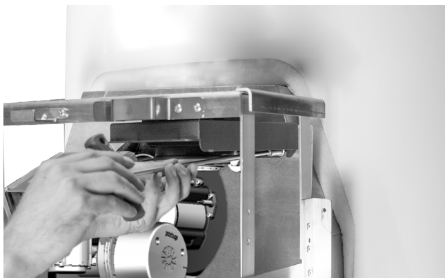
Abb. 14: Halter Balgdichtung festschrauben
