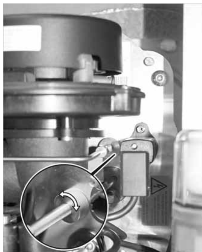
Fig. 38 : écrou moleté (raccord conduite de fioul / porte-vent)
