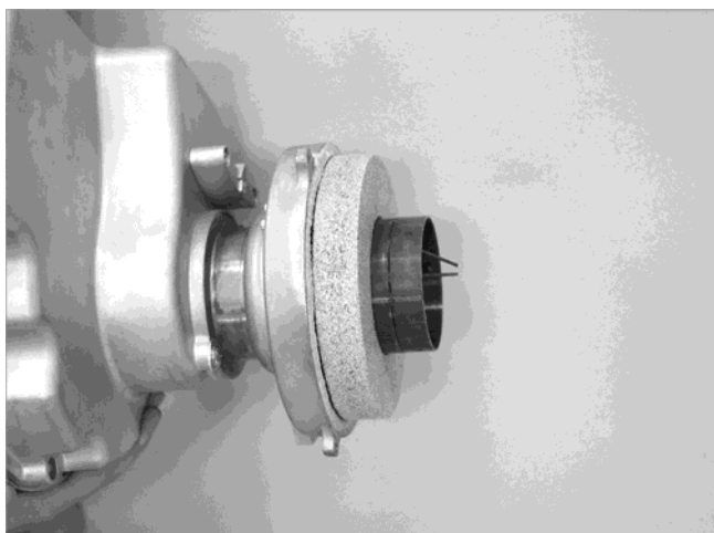
Fig. 5 : pose de la brique réfractaire de porte de chaudière
