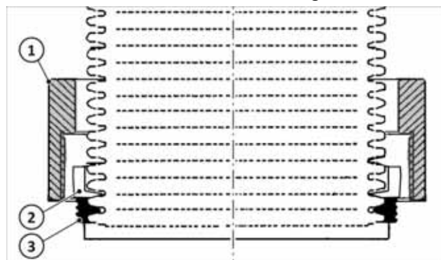
Fig. 10 : raccord vissé en place
