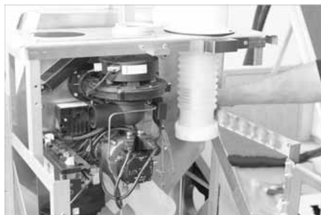
Fig.13 : positionnement droit du raccord d'évacuation des gaz
