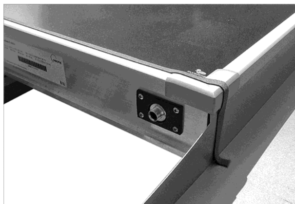
Fig. 78 : Collage d'une bande d'étanchéification sur toute la largeur de la bordure supérieure
