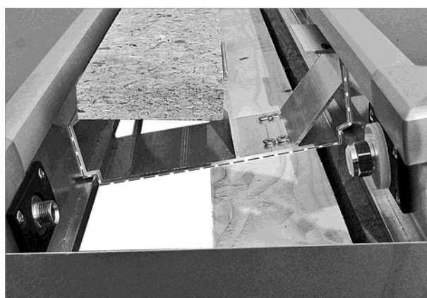
Fig. 61 : Assise des entretoises contre les capteurs
