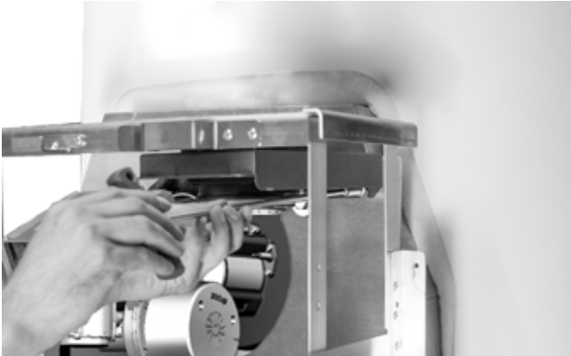
Fig. 14: Serraggio del supporto della tenuta a soffietto
