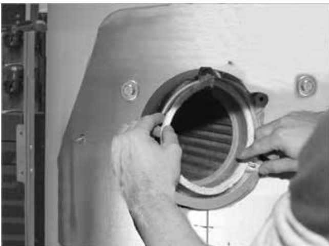
Fig. 6: Posizionamento del cordoncino di tenuta del bruciatore, a filo verso l'alto
