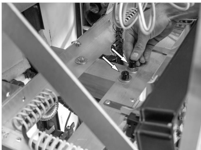
Fig. 10: Cubrir las cabezas de los tornillos
