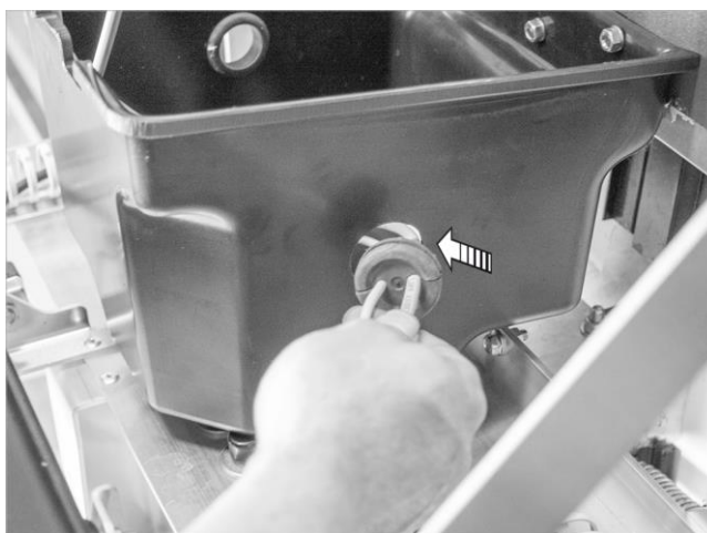
Fig. 12: Insertar herméticamente el paso de cables
