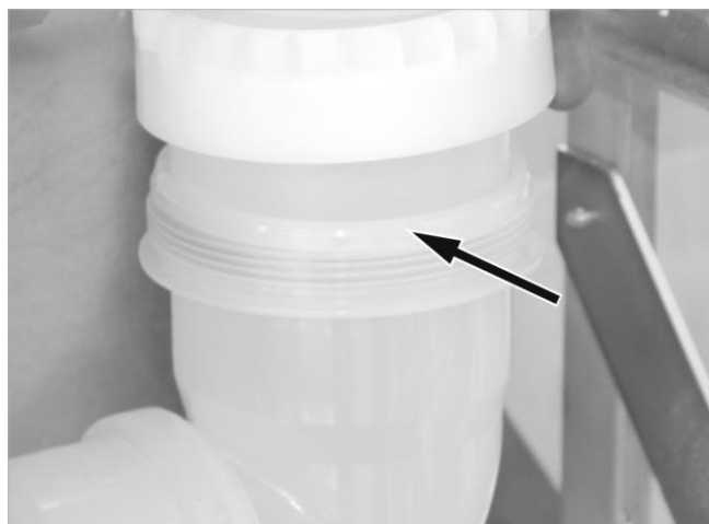
Fig. 19 : vissage du coude d'évacuation des gaz à la verticale
