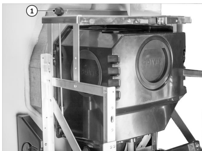
Fig. 26 : clé à douille en position rangée
