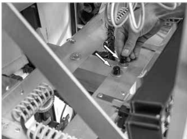
Fig. 10 : couvrir les têtes de vis de la console
