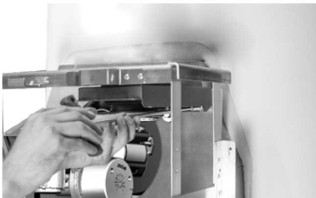
Fig. 14 : visser le support du soufflet d'étanchéité
